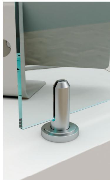
Soluzione semplice per realizzare schermi divisori in vetro di maggiore ampiezza estremamente stabili che, utilizzando vetri stratificati e temperati di spessore fino a 12,76 mm, necessitano del fissaggio sui ripiani dei banchi e delle scrivanie. Non richiede lavorazione del vetro.
